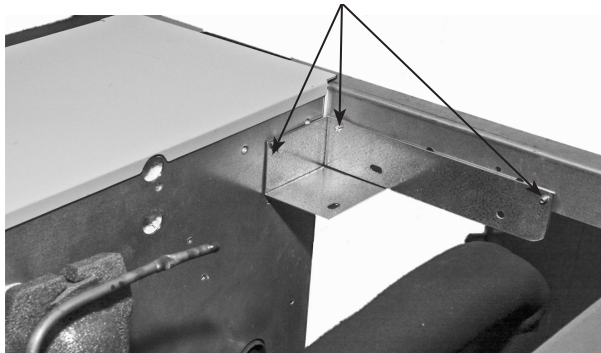
Закрепите кронштейн с помощью трех винтов
